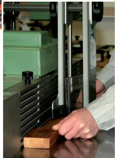
Pour le travail à l'arbre à la toupie, un dispositif de guidage à lunette intégrée doit être utilisé. Sa forme et son réglage permettent une pénétration progressive de l'outil dans la pièce. Un capot incorporé au protecteur permet de capter les poussières et les copeaux tout en réduisant les risques de contact.
