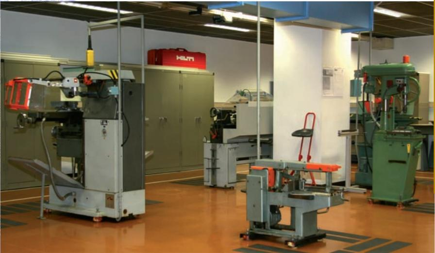
Dans l'atelier des métaux, des bandes anti-dérapantes ont été mises en place aux postes de travail afin de palier aux risques de glissades et de chutes provoquées par les projections d'huiles.
