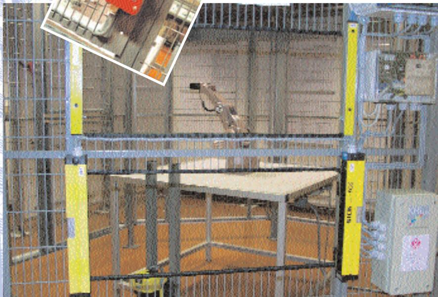
Détail d'une ouverture protégée dans la cage. Des écrans lumineux surveillant la zone dangereuse sont installés sur le bord de la cage.
