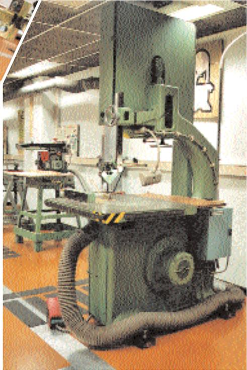
Sur la scie à ruban, un protecteur automatique de la partie travaillante du ruban a été placé. Il est adapté pour l'ensemble des travaux courants de menuiserie. Pour le délignage de petites pièces, l'utilisation des guides et poussoirs est indispensable.
