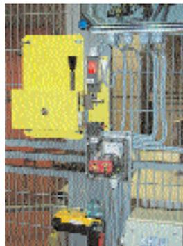
Ecran mobile avec un dispositif de blocage de la catégorie de sécurité 4.
