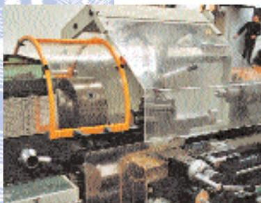
Le tour est équipé d'écrans de protection du mandrin et de la pièce travaillée afin d'éviter tout contact avec ces éléments en mouvement et de protéger les travailleurs contre les projections.
